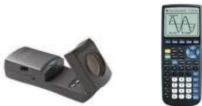
Figure 4. El Calculator Based Ranger® (a la izquierda) es un artefacto concebido para estudiar los objetos en movimiento: a través de la emisión de ondas, el CBR recoge datos de su distancia al objeto en cuestión. Al conectarse a una calculadora gráfica (por ejemplo, TI-83+®, mostrada a la derecha), es posible obtener gráficas espacio-tiempo, velocidad-tiempo, etc.
